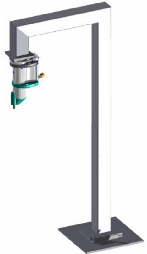
示例 - 固定型加料器的加料器支架。
