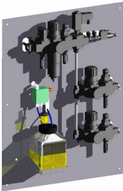
带主空气装置和润滑系统的介质控制板。
